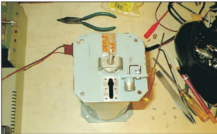
Fig. 4 - Foto d'insieme della modifica alla cavità Forem.
