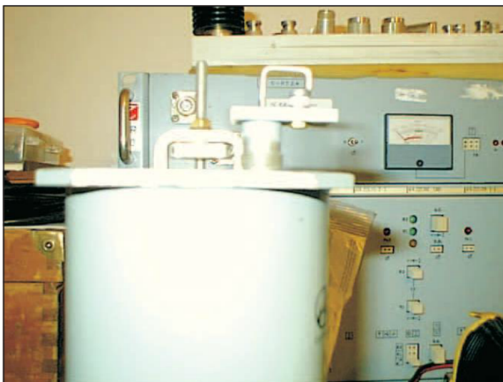
Fig. 5 - Particolare del connettore con il link in filo argentato e il condensatore
